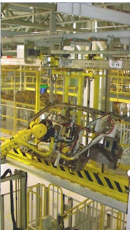
Roboterbeladung der Seitenwände Loading of side panels by robots
