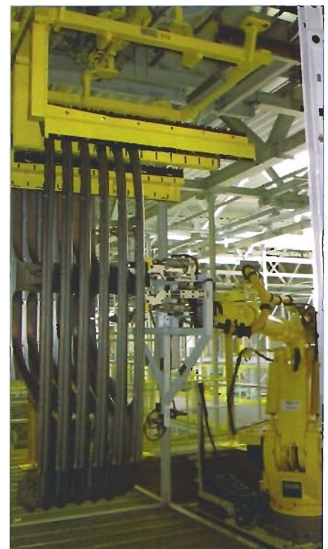
Roboterentladung der Seitenwand-Außenbleche Unloading of side outer panels by robots
