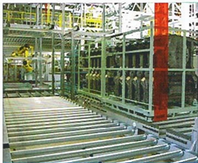
Vorzonenförderer im Hochregallager Front zone conveyor in the high-shelf warehouse
