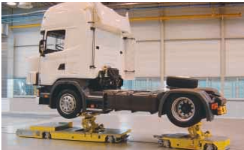
Jeder Lkw wird von einer Kombination aus Vorläufer- und Nachläuferfahrzeug getragen.
