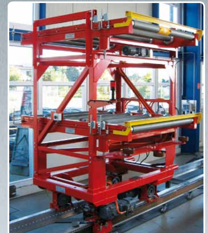
Doppelstöckiges EPB-Fahrzeug mit 2 Rollenbahnen im Testbetrieb Double-storey PPC vehicle with 2 roller conveyors during test operation
