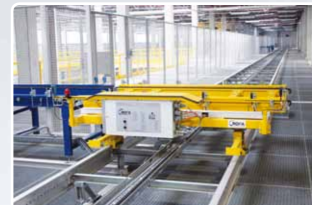
EPB-Fahrzeug an der Übergabe PPC vehicle at the transfer
