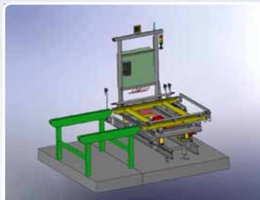
EPB-Fahrzeug und Kettenförderer bei der Übergabe PPC vehicle and chain conveyor at the transfer
