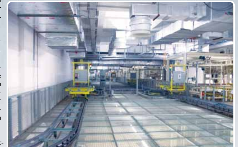
Rücktransport der leeren EPB-Fahrzeuge von den Feedern Return of empty PPC vehicles from feeders
