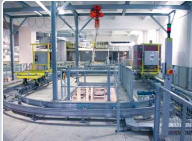
Wartungsschleife Maintenance loop
