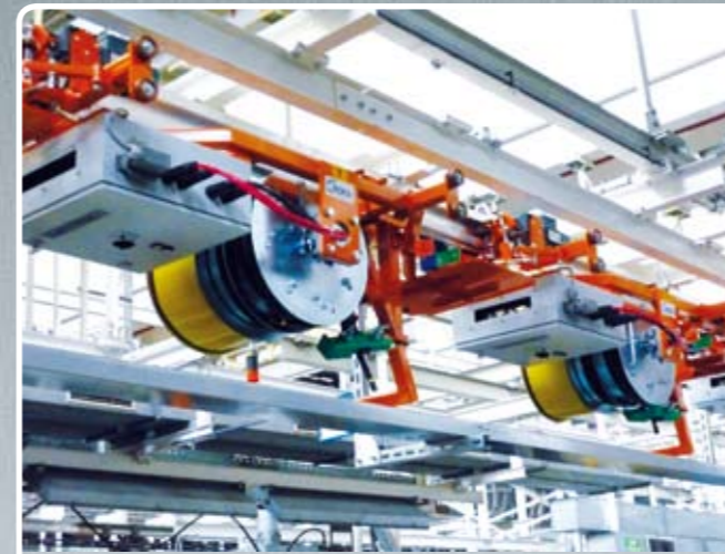
EHB KB114 bei Volkswagen in Hannover EMS KB114 at Volkswagen in Hannover
