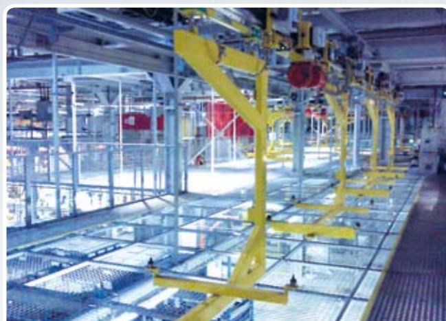
EHB-Anlage für den Transport von Vorderwagen EMS for the transport of front carriages
