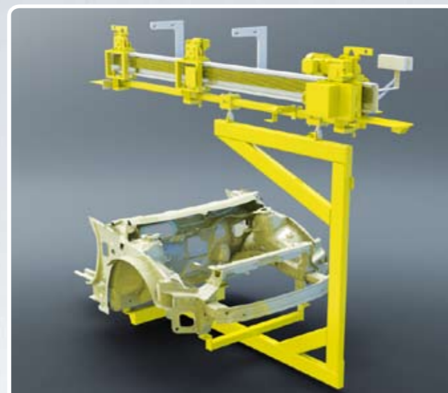
Vorderwagen EHB-Gehänge mit Bauteil Front carriage EMS carrier with component
