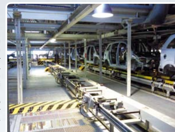
Karossenspeicher und Rollenbahn Buffer area and roller conveyor
