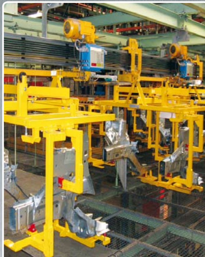
Aufpufferung in der Förderlinie Buffering in the conveying line
