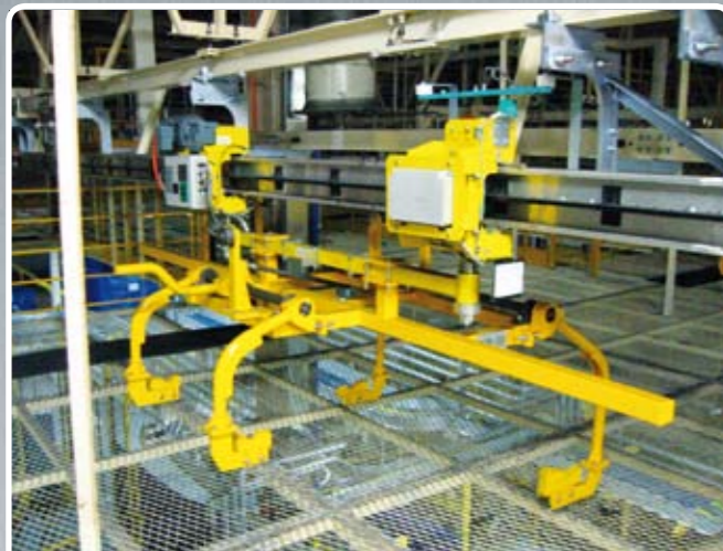
EHB-Fahrzeug mit induktiver Energieübertragung EMS-vehicle with inductive power supply
