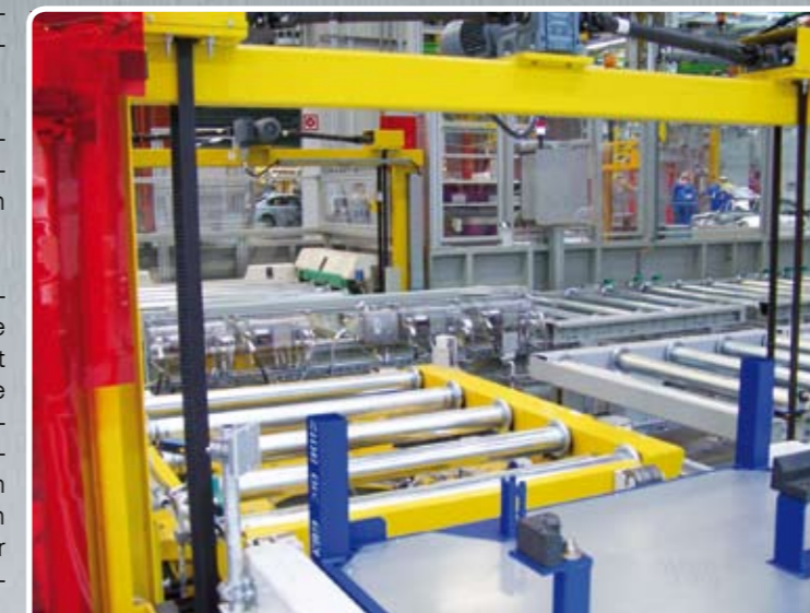
Beladestation mit angrenzendem Drehtisch Loading station and turntable
