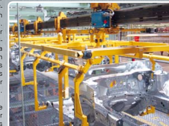
Gehänge für Bodengruppe carrier for undercarriage vehicles
