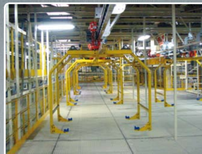
Leerstapel für Motorraumgehänge Empty buffer for motor compartment line
