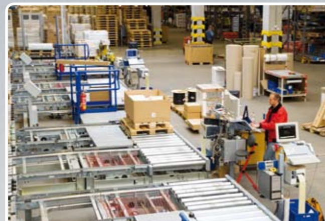
Kommissionierplätze mit Rollenbahn und Umsetzstation Commissioning stations with roller conveyors and transfer stations
