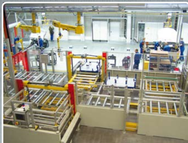
Logistikbereich mit Förderstechnikkomponenten Logistics area with conveyor components
