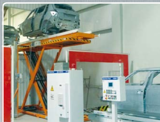
Scherenhubtisch mit 3,5 Metern Hub Scissors lifting table with 3.5 meters lift
