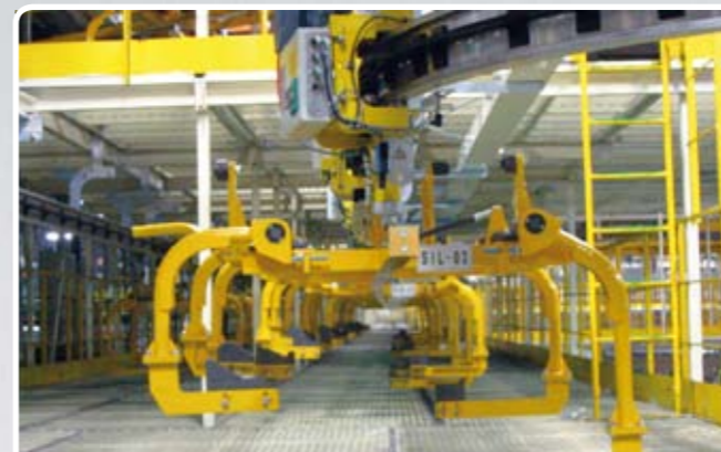
Pufferstrecke für Seitenwandgehänge Buffer line for side panel carrier
