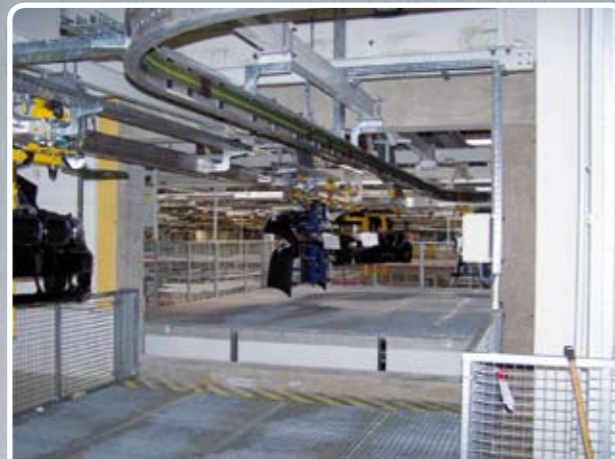
Brandschutztor mit neuer Linienführung der Frontend-EHB Fire protection door with new design of the front-end EMS
