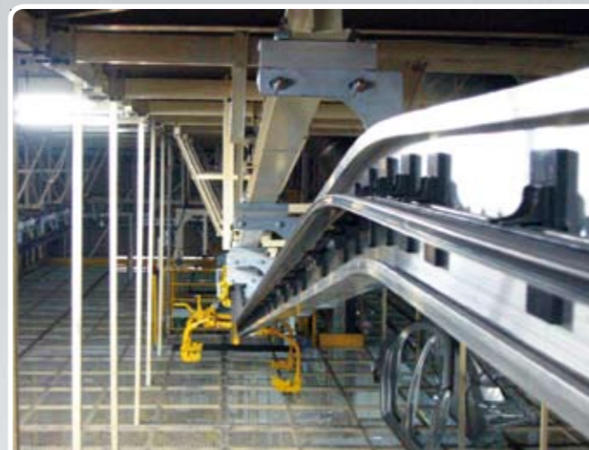
Steigstecke mit Vertikalbogen Upward sloap with vertical bend
