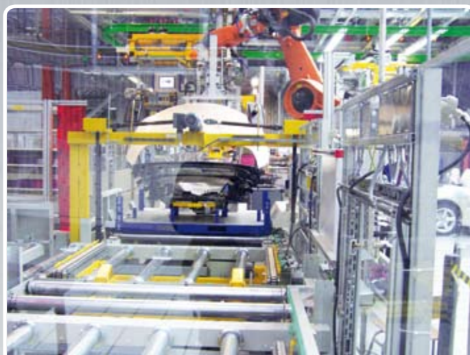
Eckumsetzer Transfer station
