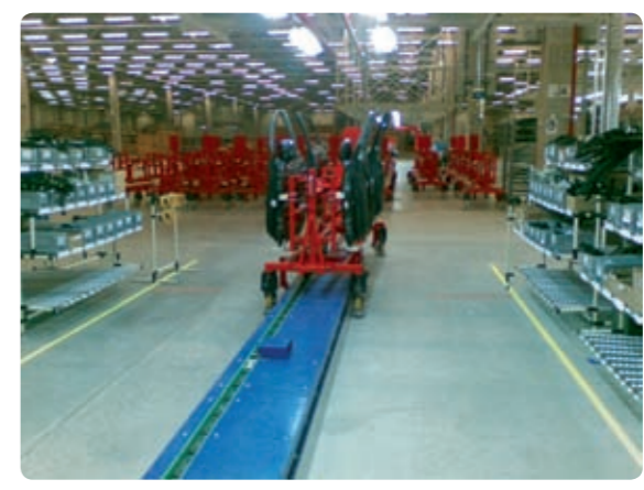
Trimlinie für die Türenvormontage Trim line for doors pre-assembly
