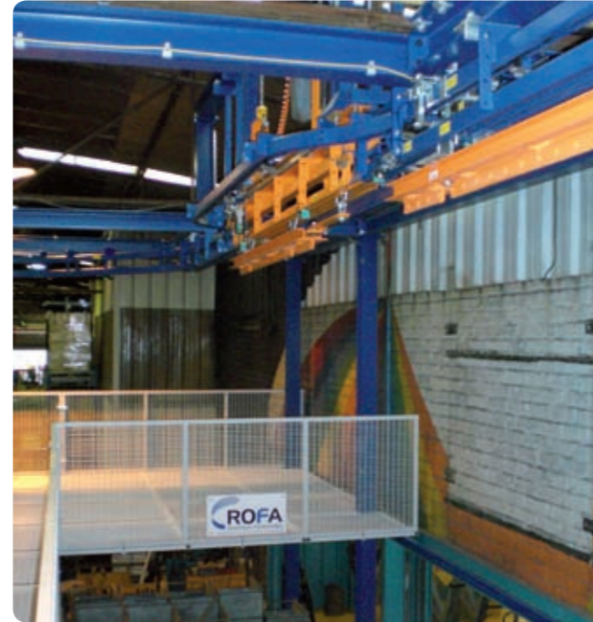
Abgabeheber: Richtung Lackierlinie Discharge station direction paint line
