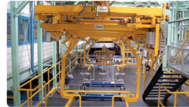
Verstellstation für Gehängeaufnahmen Pin changing station for carriers
