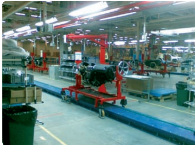
Trimlinie für Cockpitvormontage Trim line for cockpit pre-assembly
