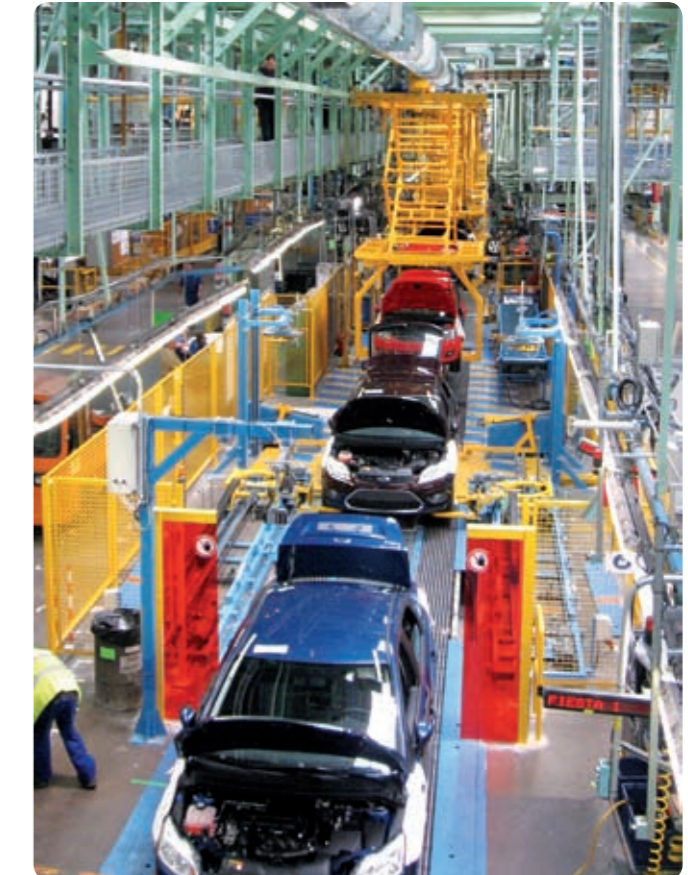
Abgabe auf das Plattenband Transfer to slat conveyor
