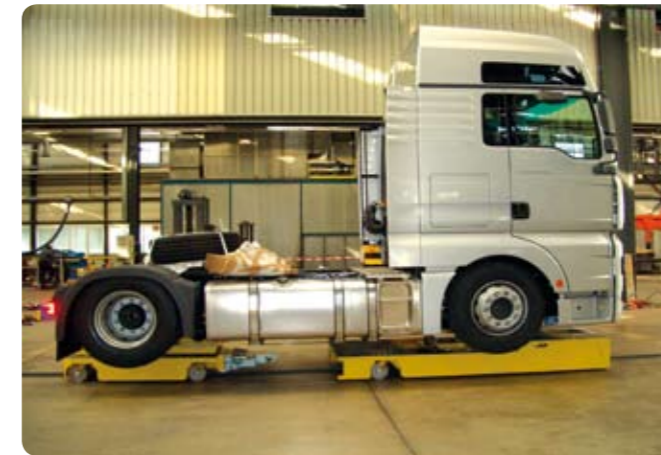
Transport eines LKW durch die Endmontage auf einem induktivem EFBi Transport of a truck through final assembly by inductive AGVi
