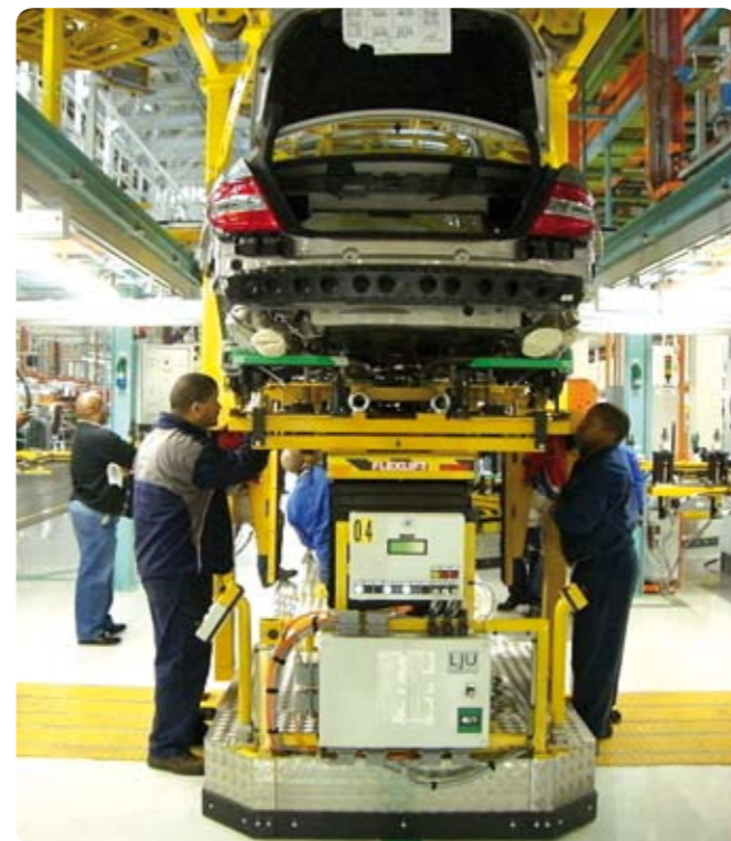
Anheben des Fahrwerks um die Hochzeit durchzuführen Lifting of the undercarriage to complete marriage
