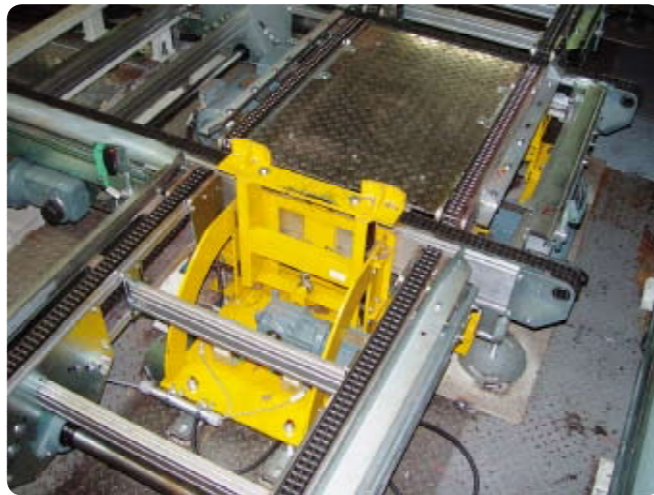
Eckumsetzer Längskette auf Querkette und elektrischer Stopper Cross transfer from cross to length chain and electrical stopper
