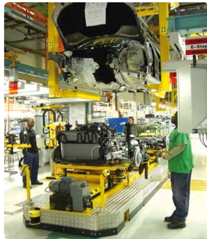
Hochzeitsstation: Absenken der Karosserie in der EHB Marriage station: lowering the chassis in the EMS
