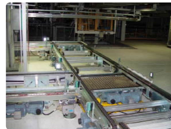
Eckumsetzer Querkette auf Längskette Cross transfer from cross to length chain conveyor
