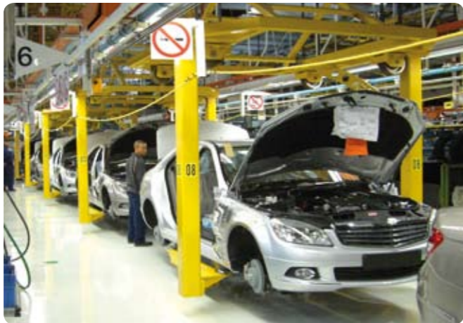
Schwerlast-EHB mit absenkbarem Gehänge für ergonomische Arbeiten an der Karosserie Endmontage Heavy-load EMS with lowerable carrier for ergonomical working
